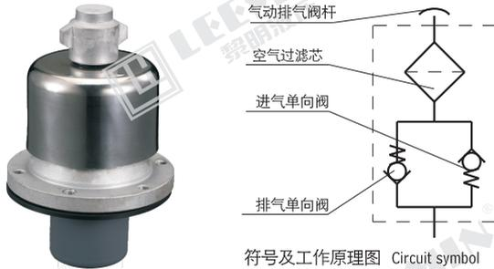
符号及工作原理图 Circuit symbol
