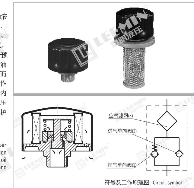
2、法兰连接 Flanged connection
